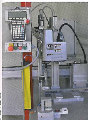
Bild 2: Der Scara-Roboter mit Doppelgreifer positioniert Metallteil und Dichttring für den Fügevorgang.
